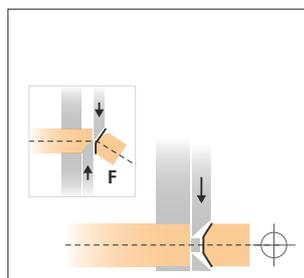
ナイフは1平面上に配置されているため、切断およびストリップ時に横方向の力を発生させません。
