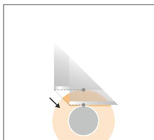
加工径によって、ナイフの刃先の接触点が異なります。
