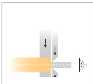
センタリングジョーとナイフは、互いに独立して、レイヤーごとにプログラム可能です。ナイフとも直線的に、またケーブル軸に直角に切断し、センタリングジョーに隣接して配置されています。
