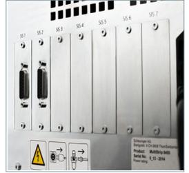
Interfaces diseñados de manera modular para acceder a todo el rango de accesorios, incluyendo pre alimentadores, sistemas de marcado, enrolladores, apiladores y dispositivos especiales.
