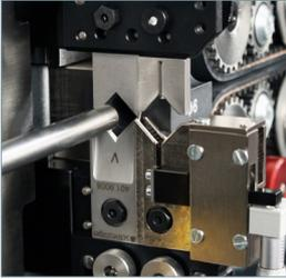
El cabezal de corte Indexable con sistema de cartuchos de navajas SmartBlade™ y sus bibliotecas de programación, permiten realizar cambios de todos los juegos de navajas de manera rápida.
