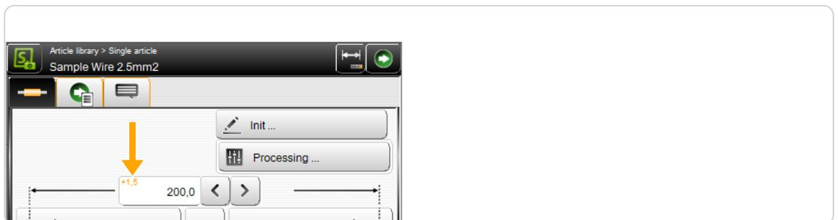
Si el modo de corrección está conectado, puede abrirse directamente el teclado táctil con la tecla **[INTRODUCIR VALOR DE CORRECCIÓN]**, donde se puede introducir directamente la longitud efectiva medida.
