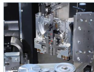
Zuverlässige und schnelle Verarbeitung unterschiedlicher Aderendhülsen dank softwaregesteuerter Anpassung der Crimpkraft an den jeweiligen Leiterquerschnitt.
